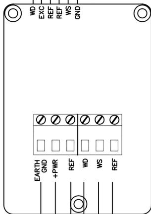
THE EARTH GROUND TERMINAL MUST BE CONNECTED TO EARTH GROUND TO PROVIDE A STATIC DISCHARGE PATH.
